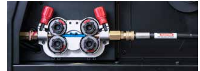
Conexión para alimentación de bidones (adaptador opcional). La menor necesidad de cambiar los carretes de hilo ahorra tiempo
